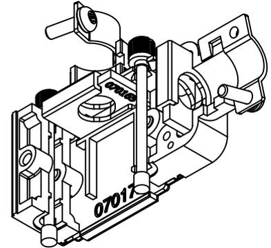
Kabeldurchmesser: max. 10 mm
