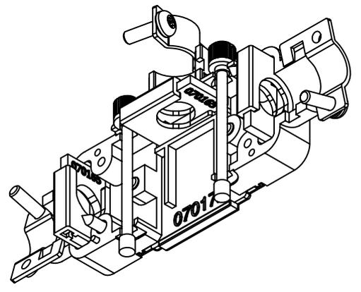
Kabeldurchmesser: max. 10 mm
